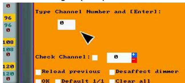
→ Au **clavier**, je tape le **numéro du circuit** auquel je veux affecter le grada. Ici, je tape 15 conformément à la feuille de patch (grada 1 → circuit 15)
